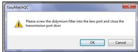
図236. デジミウムフィルター試験：RTRANポートにフィルターを設置する
