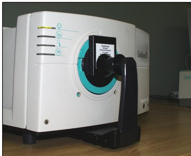
図15. 白色タイルを用いたスケール上限の設定
