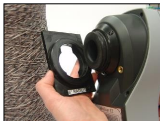
図82. ノーズコーンアダプターの装着
