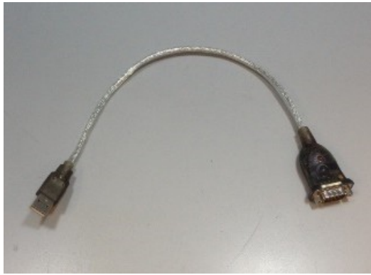
図19. USB ポート経由の接続用 RS-232-USB 変換アダプタ
