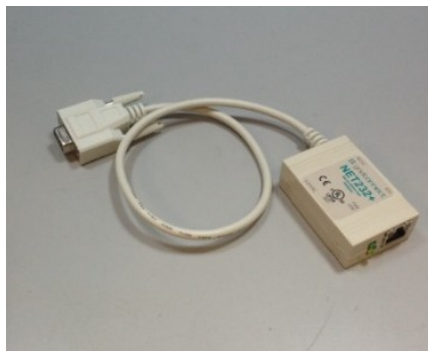
図 18. シリアルポート経由の接続用イーサネット-RS-232変換器
