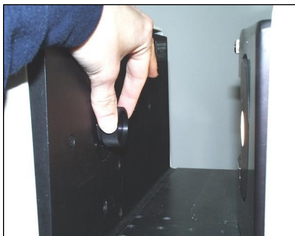
図42. ジジミウムフィルター試験：RTRANポートへのフィルター設置
