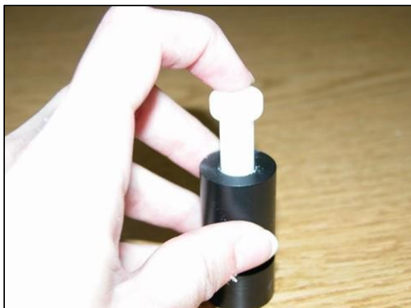
図93. プランジャーで粉末を押し固める
