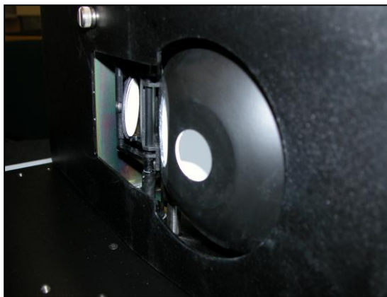
図7. 鏡面反射除去ポート開放
