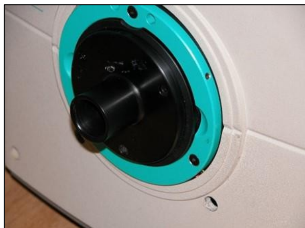
図92. ポートプレートの挿入
