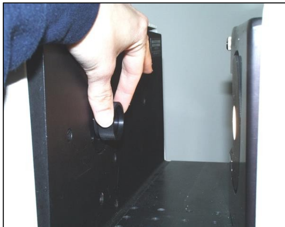
図53. デジミウムフィルターテスト：RTRANポートにフィルターを設置
