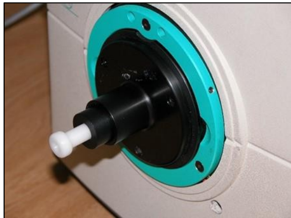
図 66. ポートプレートにパウダーホルダーを挿入する
