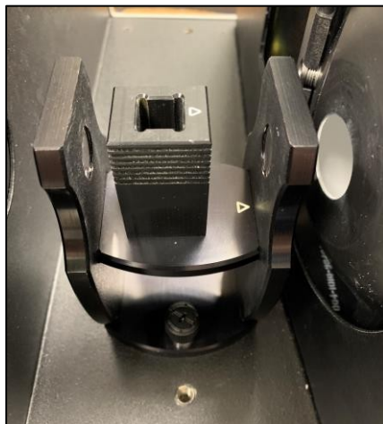
図73. セルホルダーの取り付け状態
