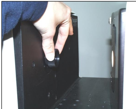
図42. ディディミウムフィルターテスト: RTRANポートにフィルターを取り付ける
