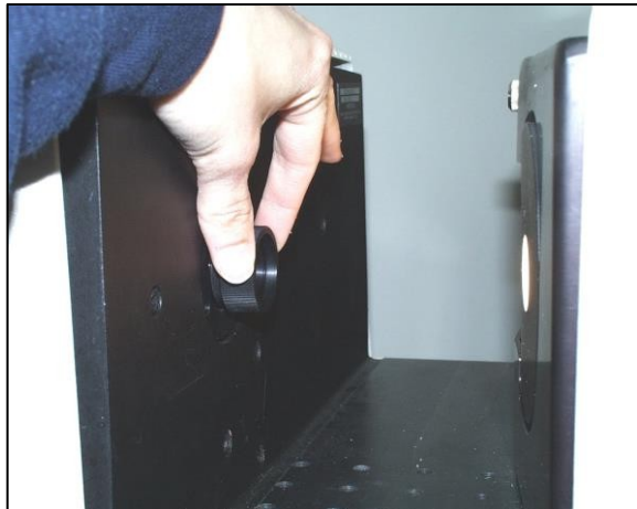
図53. ディディミウムフィルターテスト: RTRANポートにフィルターを取り付ける
