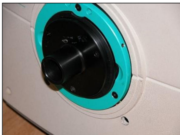
図92. ポートプレートの挿入
