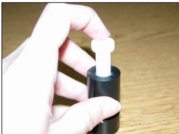
図93. プランジャーで粉末を押し固める
