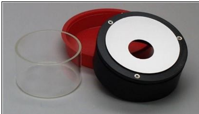
図73. 改良型ポートインサート、キャップ、およびサンプルカップ
