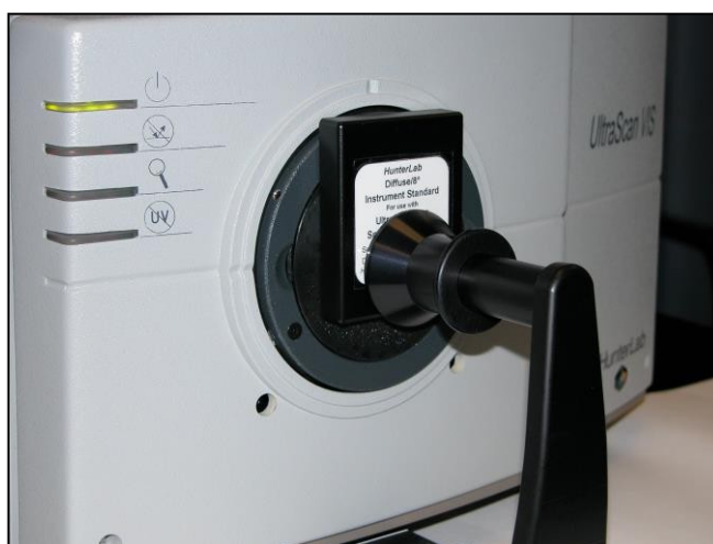
図25. 白色タイルを用いた標準化
