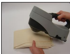
図65. 不透明でない試料の測定
