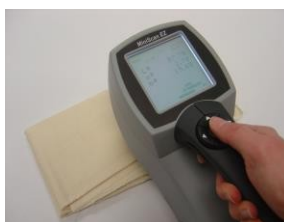
図64. 薄くて柔らかい素材の測定
