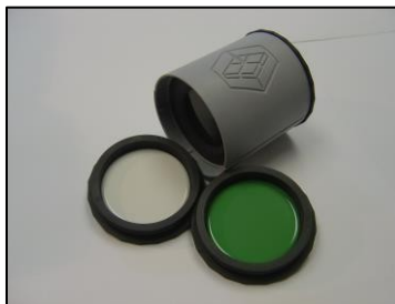
図16. キャリブレーションシリンダー
