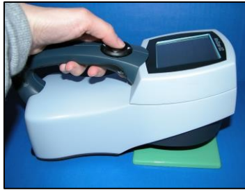
図24. 標準液または試料の測定
