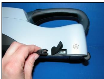
図8. USBケーブルの接続
