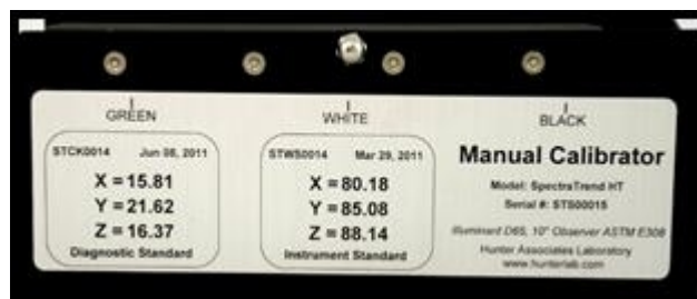
図3. スライドオン校正器の校正値
