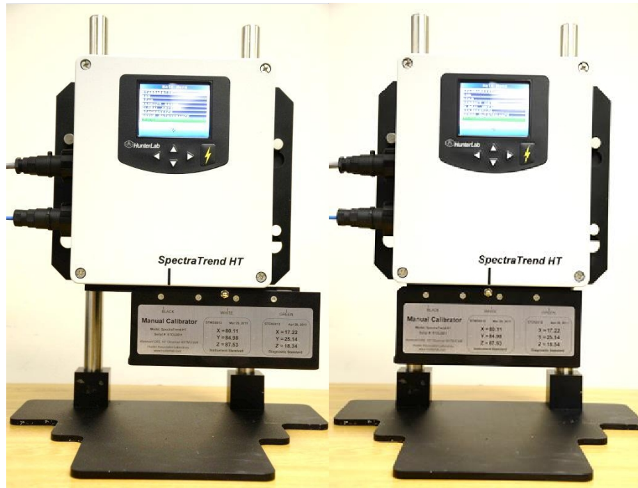
図 10. 校正器をスライドさせる
